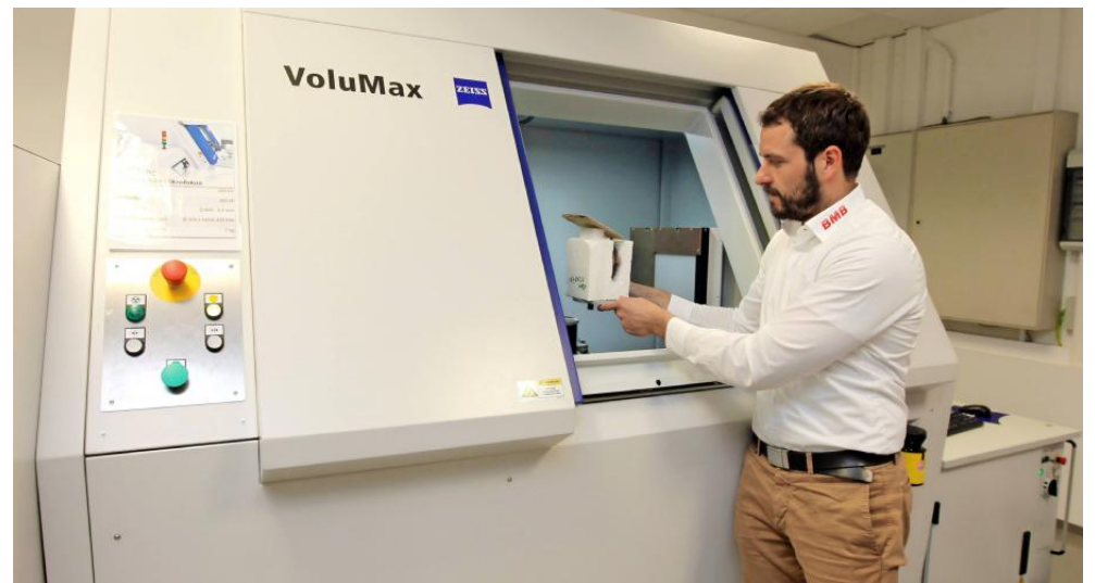
Steffen Buchmüller, technischer Projektmanager bei BMB, bereitet ein Siegel für die Untersuchung in einem hochkomplexen Mikro-CT vor.
